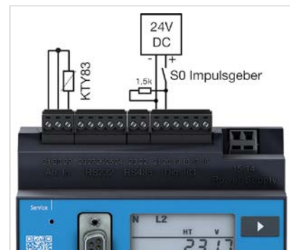
Abb.: Beispiel Temperatureingang (KTY83) und S0-Impulsgeber
