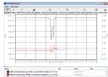
Abb.: Kritischer Spannungseinbruch mit Fertigungsstillstand
