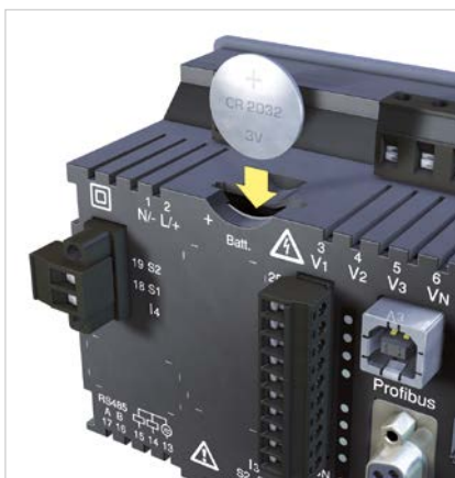
Abb.: UMG 96RM-P mit Batterieeinschub auf der Rückseite
