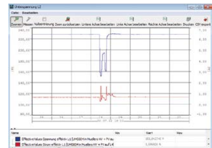
Abb. 11: Kritischer Spannungseinbruch mit Fertigungsstillstand
